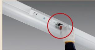
2. 電池接続コネクタを外し、電池を引き出します。
