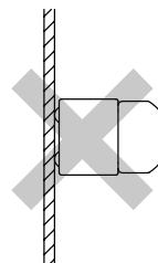
電源回路側の側面ノックアウト穴は、電源線を引き込むスペースがないため使用できません。
