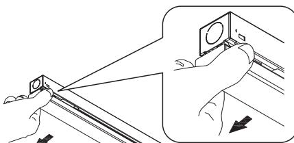
(2) スライドにより空いた隙間にマイナスドライバーなどを差し込みライト棒を矢印の方向に引き下げ爪をはずしていくとライト棒が外れます。
